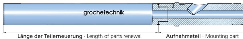
Der Zylinder wird im Einfüllbereich abgetrennt und ein neues Bimetall-Rohr schlagfrei verschraubt und verschweißt. Die Bohrung wird von hinten gehont, um einen möglichst sauberen Bohrungsübergang herzustellen.
