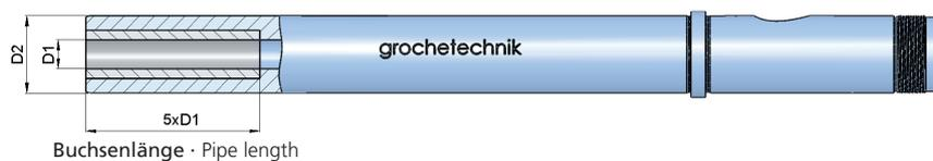
Der Zylinder wird 5 L/D tief ausgedreht, eine Buchse mit Original-Durchmesser wird eingeschrumpft. Die Bohrung wird von hinten gehont, um einen möglichst sauberen Bohrungsübergang herzustellen.
